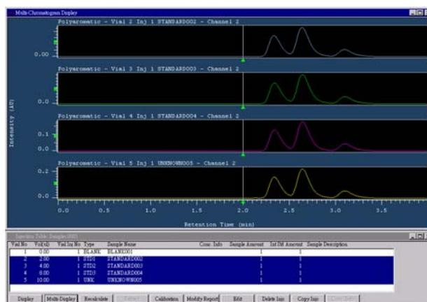
2. 若是要將層析圖重疊比較，再到 Menu Bar / Option 內選擇 Overlay，並將滑鼠移至 Y 軸按下右鍵就可以達到重疊比較的效果。
