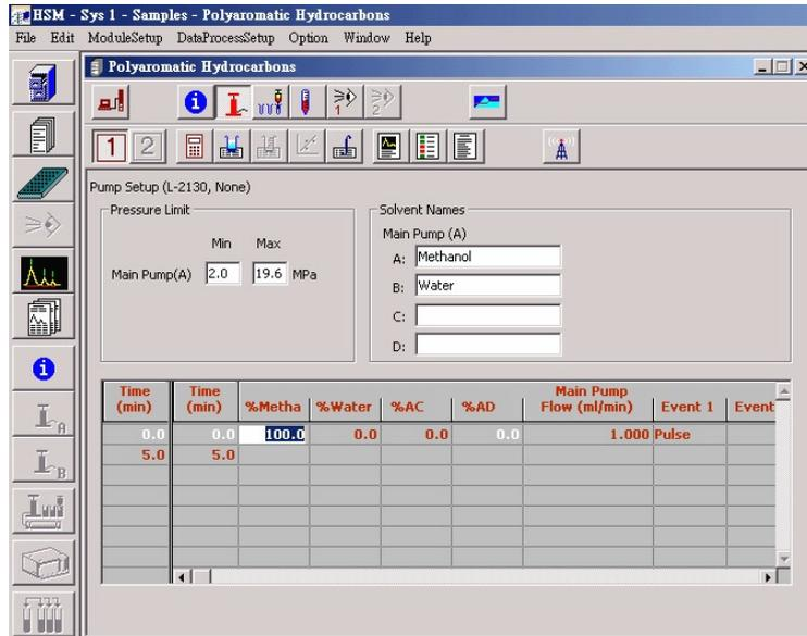
2. 在這裡可設定幫浦的最大最小壓力(Pressure Limit)及濃度梯度的設定(時間，溶劑比例和流量)。
