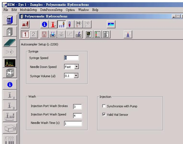
2. Syringe: 可以設定注射筒的速度，注射針下降速度和注射筒體積。
