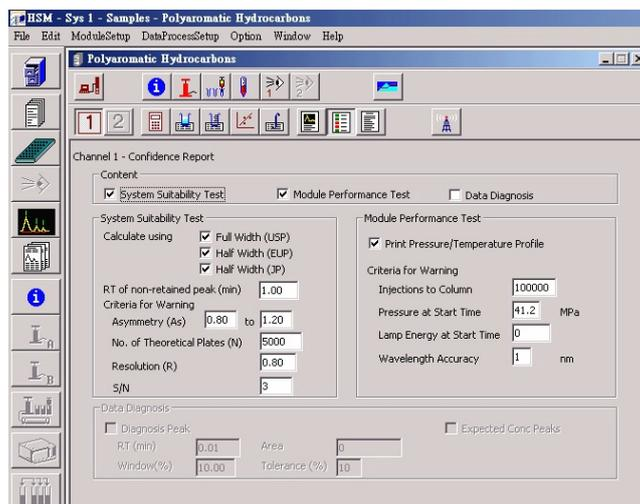
2. 在 Content 選擇所要作的測試—系統適當測試(System Suitability Test.....(SST))，標準性能測試(Module Performance Test)，數據診斷(Data Diagnosis)。
