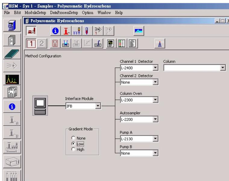
在各別的組成內，選擇符合目前 HPLC 組合的型號，幫浦模式和 Column 編號。
